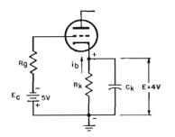
Fig. 5A — Sistema di polarizzazione combinata. La tensione desiderata è fornita in parte dalla batteria, ed in parte dalla caduta ai capi della resistenza di catodo.
