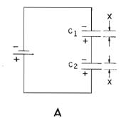
Fig. 4 — Se colleghiamo due condensatori in serie,  $C_1 \in C_2$ , aventi ciascuno uno spessore « X » di dielettrico (figura A), avremo lo stesso effetto che se impiegassimo un condensatore unico, CT, con spessore del dielettrico (figura B) pari alla somma degli spessori (2X): in altre parole, minore capacità. Per contro, avremo una tensione ammissibile di lavoro molto più alta.
