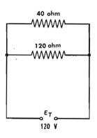
Fig. 8 — Un altro metodo per ricavare la resistenza equivalente di un circuito con resistenze in parallelo è quello dell'« equazione ». È utile **quando** gli elementi sono solo due. Il metodo deriva dal fatto che la resistenza equivalente di due resistenze in parallelo è pari al loro prodotto diviso per la loro somma.
