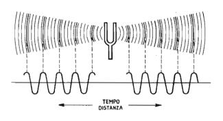
Fig. 3. - Scegliendo opportunamente materiale e dimensioni nella realizzazione di una **forcella metallica si può - ponen**dola in vibrazione - far sì che la vibrazione stessa **ris**ulti di una data frequenza: è il caso del **diapaso**n, qui illustrato.
