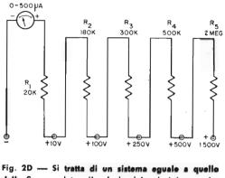
della figura a lato: il calcolo dei valori è eseguito nello stesso modo. La scelta delle portate avviene con lo spostamento di un puntale.
