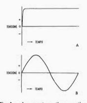
Fig. 1 — La corrente continua mantiene la sua ampiezza (A), quella alternata la cambia continuamente (B).
