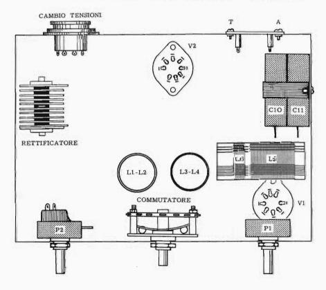
Fig. 4 — Veduta all'interno dello chassis di cui sopra. Il comando di gamma (commutatore) rimane sotto a quello del condensatore variabile di sintonia CV1 : è bene perciò dotare il commutatore di bottone piccolo per non impedire l'uso di una manopola grande per CV1. I condensatori elettrolitici C10 e C11 possono essere anche del tipo tubolare.
