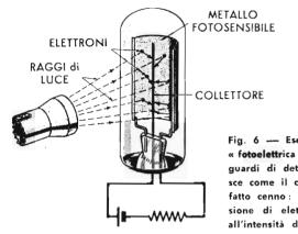
Fig. 6 — Esempio di emissione « fotoelettrica ». La luce, nei riguardi di determinati corpi, agisce come il calore al quale si è fatto cenno: si ha così un'emissione di elettroni proporzionale all'intensità della luce incidente.
