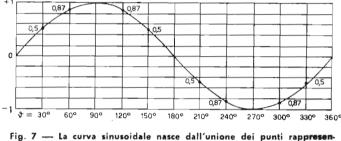
Fig. 7 ---- La curva sinusoidale nasce dall'unione dei punti rapp**resen**tanti i valori di seno dell'angolo ϑ.
