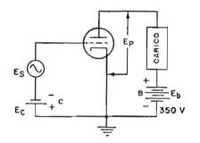
Fig. 1A — Circuito tipico di amplificatore a triodo. La batteria B fornisce la tensione anodica, mentre la batteria C fornisce la tensione di polarizzazione di griglia. Tutta la corrente anodica passa attraverso il carico.
