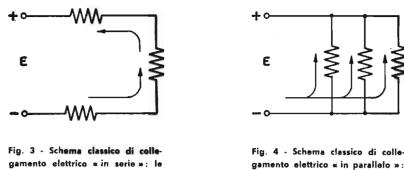
Fig. 4 - Schema classico di collegamento elettrico « in parallelo » : le tre resistenze sono in derivazione l'una rispetto all'altra. La corrente ha tre percorsi.
