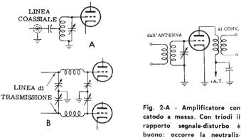
Fig. 1 - Circuiti di ingresso di amplificatori a radiofreguenza.
