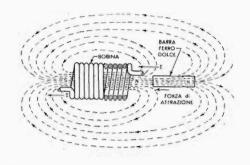
Fig. 2 — Se una barra di ferro dolce viene posta nelle vicinanze di un elettromagnete, essa si magnetizza a sua volta e viene attratta all'interno della bobina.
