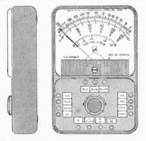
Fig. 1 — Veduta di fianco e frontale del « tester ». L'ingombro, molto limitato, lo rende addirittura « tascabile ». La lunghezza è di 12,6 cm, la larghezza di 8,5 cm e lo spessore di 2,8 cm. Caratteristico è l'ampio quadrante che, unitamente all'assenza della abituale cornice dello strumento, consente chiare e precise letture.
