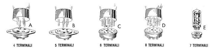
Fig. 1 — Vari tipi di zoccoli di valvole, raffigurati unitamente ai rispettivi portavalvole. In A il classico tipo a 4 piedini, due dei quali hanno un diametro maggiore. In B il tipo a 5 piedini disposti a pentagono irregolare. In C il tipo detto « octal », a 8 piedini. In D un tipo analogo a fissaggio automatico, ed in E il tipo « miniatura », i cui contatti escono dal bulbo.
