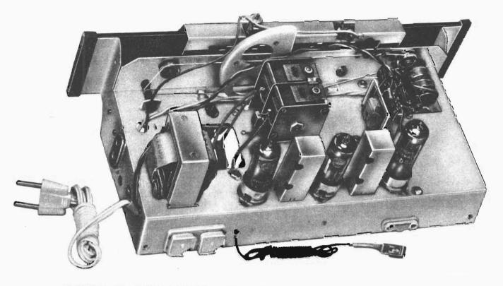
La fotografia completa il disegno della pagina a fianco. Sono chiaramente visibili, nei trasformatori di Media Frequenza, i fori necessari per accedere alle viti di taratura: il foro superiore è quello relativo all'avvolgimento primario. E' illustrato anche l'impiego dei gommini di protezione da porsi ai bordi del cristallo della scala parlante.
