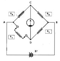
Fig. 1 Schema di di principio del Ponte Wheatstone. Si hanno tre elementi noti (Ra -Rb - Rs) e quello incognito: Rx, una sorgente di energia BT e lo strumento che indica l'equilibrio.
