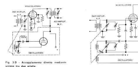
Fig. 4 - L'eptodo (valvola con cinque griglie), può funzionare da stadio mescolatore. Un triodo separato produce le oscillazioni, che vengono sovrapposte a quelle in arrigrazie all'acvo coppiamento con la terza griglia dello eptodo mescolatore.
