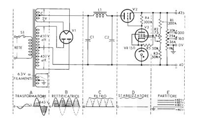
Fig. 9 — Alimentatore completo con tensioni anodiche d'uscita stabilizzate e regolate. La sezione di stabilizzazione è eguale a quella già illustrata a figura 6. In basso, in corrispondenza delle diverse sezioni, sono riportate le forme d'onda relative. Un alimentatore analogo, ma dotato di più complete caratteristiche, è argomento principale della 51<sup>a</sup> lezione.
