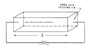
Fig. 12 - Un conduttore elettrice oppone una certa « resistenza » al libero passaggio della corrente : tale resistenza dipende dalla natura del materiale di cui il conduttore è formato, dalla sua lunghezza « I » e dall'area della sua sezione, A.
