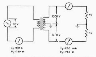
Fig. 13 — Trasformatore di media potenza preso ad esempio per il calcolo della potenza primaria considerando il rendimento, e della corrente considerando il fattore di potenza.
