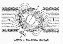
Fig. 9B - Linee di forza prodotte dalla corrente che circola nell'avvolgimento del rotore, supponendo che lo statore non sia magnetizzato. Fig. 9C - Campo magnetico risultante dalla sovrapposizione dei due campi (rotore e statore). Come si può osservare l'asse zero del campo risulta in tal caso inclinato, e ciò dà luogo a scintillio sui collettore.
