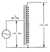
Fig. 1-A — Caso dell'autotrasformatore elevatore. La tensione primaria è minore della tensione secondaria. l., rappresenta la corrente a vuoto.
