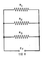
Fig. 7 — In un circuito **in para**llelo per trovare il valore della resistenza **equivalente si può seguire** il metodo della « conduttanza ». In base a tale metodo si deve ricordare che l'inverso della resistenza totale è pari alla somma dell'inverso di ogni singola resistenza. Trovata la resistenza equivalente si ricava il valore di corrente totale con la legge di Ohm.
