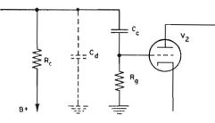
Fig. 7 — La reattanza di C<sub>c</sub> e la resistenza  $R_g$  costituiscono un partitore che attenua il segnale alle frequenze basse. Nei confronti delle alte — invece — l'attenuazione è data dalle capacità parassite, rappresentate da C<sub>d</sub>.
