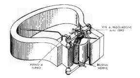
Fig. 11D — Le diverse parti sin qui esaminate, nel loro assieme di montaggio costituente l'intero strumento. Completano quest'ultimo una vite di regolazione dell'indice (piccoli spostamenti) per farlo coincidere con lo zero della scala, a riposo, e due perni d'arresto ai due lati estremi della **corsa**.
