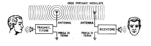
Fig. 8 - Le onde sonore o « informazioni » vengono, mediante la modulazione, abbinate - nel trasmettitore alle onde elettromagnetiche da quest'ultimo generate. La informazione viene portata dalle onde **elettro**magnetiche (da cui il nome di « portante ») al ricevitore, ove ha luogo il processo inverso a quello che si svolge nel trasmettitore.
