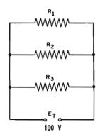
Fig. 9 — Un terzo metodo, infine, per ricavare la resistenza equivalente di un circuito in parallelo è quello detto della « tensione fittizia ». Si prende a base una tensione qualsiasi (meglio se a fattore 10 o multiplo di 10) e con essa — applicando la legge di Ohm per ogni ramo — si ricavano le correnti che, sommate, serviranno per ottenere « Re ».
