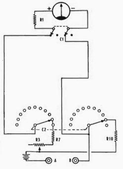
Sulla base di quanto è stato esposto alla lezione precedente nei riguardi degli ohmetri, risulta che lo schema è quello del tipo cosiddetto « in serie ». Infatti la resistenza incognita, inserita tra A e B, viene a trovarsi in serie al circuito alimentato dalla apposita batteria. Nella portata di cui allo schema ( $R \times 1$ ) la seconda sezione di  $C_2$ inserisce in parallelo una apposita resistenza (portate basse).
