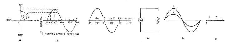
Fig. 8 — Rappresentazione vettoriale (in A) e con curva sinusoidale (in B) della corrente alternata. In A è raffigurato il vettore rotante solo durante il primo quarto di periodo.
