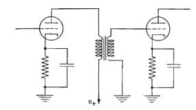
Fig. 9A ---- Accoppiamento a trasformatore. È simile all'accoppiamento LC, con la differenza che il segnale trasferito allo stadio successivo può avere una ampiezza maggiore o minore, a seconda del rapporto tra le spire.
