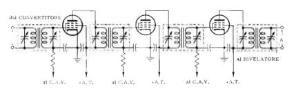
Fig. 10 - Amplificatore di media frequenza, a tre stadi. Comporta otto circuiti sintonizzati e la curva di responso finale deriva dalla sovrapposizione delle curve di tali circuiti. Ogni stadio restringe l'ampiezza di banda, vale a dire, aumenta la selettività.
