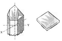
Fig. 9 - Dalla massa originale di un cristallo di quarzo, vengono ricavati, mediante tagli secondo determinati assi, i veri e propri cristalli adatti al controllo della frequenza di un oscillatore a quarzo.
