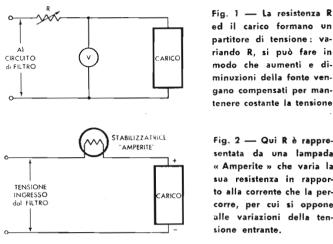
Fig. 1 — La resistenza R ed il carico formano un partitore di tensione : variando R, si può fare in modo che aumenti e diminuzioni della fonte vengano compensati per mantenere costante la tensione
