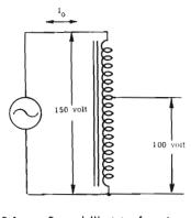
Fig. 2-A — Caso dell'autotrasformatore riduttore. La tensione primaria è maggiore della tensione secondaria. Esiste sempre una corrente a vuoto.
