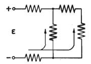
Fig. 5 - Schema classico di collegamento elettrico misto: le resistenze sono unite tra loro in varie combinazioni serie-parallelo.
