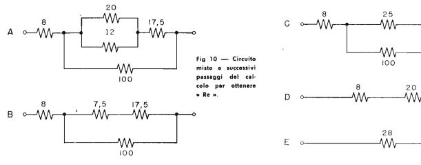
legge di Ohm. La potenza dissipata in un circuito è eguale alla somma delle potenze dissipate nei vari rami, come segue:
