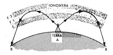
Fig. 12 - Le onde che pervengono alla jonosfera vengono spesso rifratte e per questi cambiamenti di direzione (da E ad  $F_1$ - $F_2$ ) pos**sene** tornare sulla terra permettendo una comunicazione a lunga distanza tra A e B.
