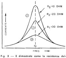
Fig. 3 — E dimostrato come la resistenza dell'antenna abbia importanza sulla selettività e sul rendimento.
