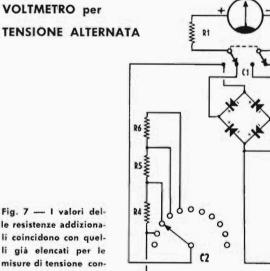
le resistenze addizionali coincidono con quelli già elencati per le misure di tensione continua. Il raddrizzatore a ponte inserito, rettifica entrambe le semionde.
