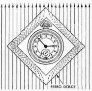
Fig. 14 - Per proteggere un oggetto dai campi magnetici si può racchiuderlo in un involucro di materiale magnetico, che assorbe e devia le linee di forza.
