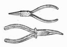
Fig. 1 - Due tra i più comuni tipi di pinze per il lavoro del radiotecnico: il tipo a punte tonde, utile in particolare per fare occhielli alle estremità dei fili di collegamento, e quello a punta curva, per accedere a dadi in posizioni difficilmente accessibili.
