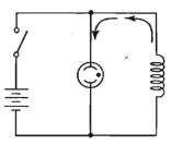
Fig. 5 — La restituzione di energia effettuata dall'induttanza allorchè il circuito viene aperto, provoca l'accensione della lampadina che a circuito chiuso non si illumina per una troppo bassa tensione.
