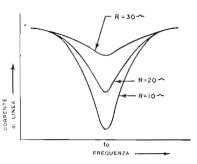
Fig. 9 — Aumentando la resistenza nel circuito, la corrente induttiva e quella capacitiva si elidono sempre meno, la corrente di linea aumenta e la curva di risonanza si appiattisce.
