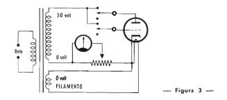
prova si comporta come rettificatrice di una semionda e tutta la corrente emessa dal catodo viene trasferita ad un unico terminale (anodo) attraverso il quale prosegue alla volta dello strumento.
