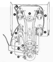
Fig. 6 - Collegamenti tra il commutatore di gamma e le relative bobine. Sono visibili anche le bobine della gamma «E».
