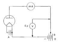
Fig. 10 A — Trascrivendo le letture del voltmetro « V » e del misuratore di corrente « mA » dopo spostamenti successivi della presa sulla batteria « B », si può tracciare una curva caratteristica del diodo.
