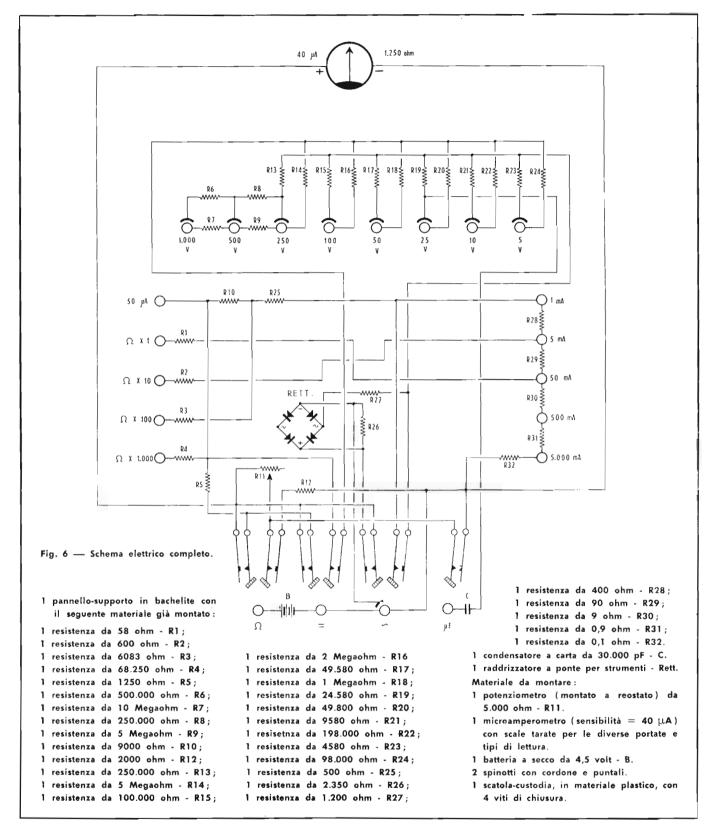
vata sensibilità propria dello strumento indicatore, si è potuto, con una tensione limitata a 4.5 volt, portare la lettura fino a 20 Megaohm (ultima indicazione sulla scala — 20 K — moltiplicato per 1.000).  $R_{11}$  è, naturalmente, la resistenza variabile di azzeramento ed  $R_{12}$  quella di protezione.
