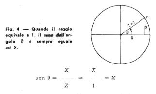
per cui se il raggio, ossia l'ipotenusa, equivale a uno, la lunghezza di X (la componente verticale) sarà sempre il seno dell'angolo.
