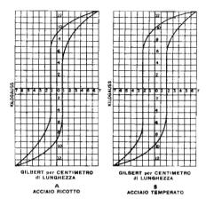
Fig. 18 - Confronto tra le curve di isteresi dell'acciaio ricotto e dell'acciaio temperato.
