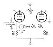
Fig. 5A --- Voltmetro elettronico a circuito bilanciato. È adatto alla misura di tensioni continue negative. La resistenza R<sub>B</sub> può assumere vari valori, mediante un commutatore, per le varie portate a fondo scala.
