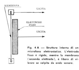
ta se il valore della capacità varia periodicamente; la corrente alternata che circola in tali condizioni, ha una intensità direttamente proporzionale alla variazione di capacità.
