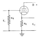
Fig. 11 — Stadio con uscita catodica. Il segnale si sviluppa ai capi di R<sub>k</sub> ed è in fase col segnale di griglia. Non amplifica.
