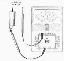
Fig. 9 — Analizzatore predisposto come misuratore d'uscita. Possono essere impiegate tutte le portate per tensione alternata, ma è necessario interporre, come è illustrato, un condensatore « C » da 10.000 pF per salvaguardare il circuito di misura dalla presenza di eventuale componente di corrente continua. Nel testo è spiegato come deve essere interpretata l'apposita scala.
