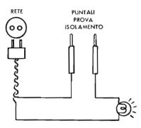
Fig. 17 --- Con due puntali così predisposti si possono eseguire alcune prove di isolamento del trasformatore che, sebbene assai modeste, sono tuttavia utili e precauzionali.
