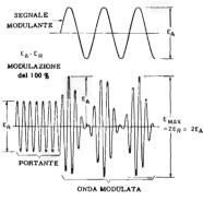
Fig. 3 — Per una modulazione al 100 % il segnale modulante oscilla con ampiezza sufficiente a raddoppiare o a ridurre a zero l'ampiezza della portante.
