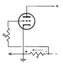
Fig. 6 — Polarizzazione fissa mediante una resistenza in serie al lato negativo dell'alimentazione.  $R_s$  fa capo al terminale di R più negativo che non quello a massa.
