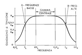
Fig. 9 — Curva relativa ad un trasformatore d'uscița: è simile a quella di un accoppiamento RC. A e B indicano due livelli a metà potenza.
