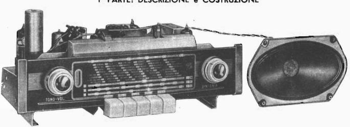
COSTRUZIONE di un RICEVITORE SUPERETERODINA per O. Medie e Corte I<sup>o</sup> PARTE: DESCRIZIONE e COSTRUZIONE
