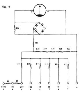
Per la disposizione delle resistenze si può notare molta analogia con lo schema riportato a fianco. Oltre al caratteristico impiego del gruppo raddrizzatore (**figura 4**)  $\doteq$ da far osservare che la serie di resistenze addizionali (da  $R_{zx}$  a  $R_{z}$ ) è diversa da quella di cui si usufruisce nelle misure di tensione continua: infatti si hanno qui 1.000 ohm per volt in luogo di 20.000 ohm, da cui 4.580 ohm, ad esempio ( $R_{zx}$ ) in luogo di 98.000 ohm ( $R_{zx}$ ).
