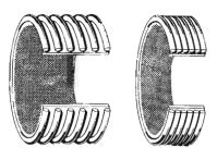
Fig. 6 — Anche con supporto, se di ceramica, si realizzano bobine per frequenze elevate: possono essere a spire distanziate (conduttore nudo) o a spire affiancate (conduttore isolato).
