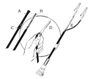
Fig. 11 - Preparazione dei terminali cui vanno applicate le pinze a coccodrillo. La lunghezza dei due segmenti (circa 10 cm), è sufficiente per consentire il collegamento ai vari punti del circuito del ricevitore sotto prova.
