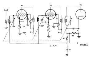
Fig. 15 --- Amplificatore ad Alta Frequenza a stadi accordati. Il circuito del C.A.V. è messo in rilievo con tratto più grosso.
