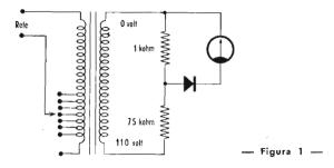
stesso-su un apposito contrassegno segnato « line test » (controllo rete). Scopo evidente di questo controllo è di garantire che alla valvola sotto prova vengano applicate le tensioni esatte, rendendo minime le possibilità di un errore di lettura dovuto alla presenza di tensioni troppo alte o troppo basse. Il secondo circuito a mezzo di commutatori predispone il
