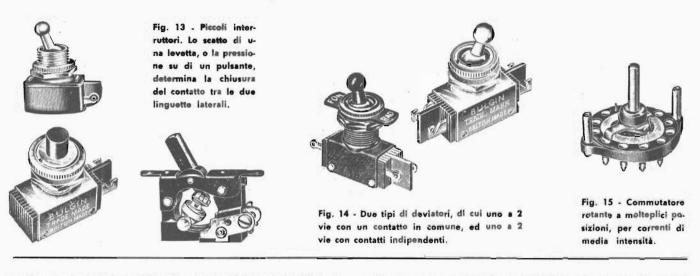
anche come, assai spesso, sia necessario disporre di un dispositivo che permetta di inviare la medesima corrente su vari conduttori, contemporaneamente o separatamente; per ottenere ciò si impiegano accessori analoghi ai deviatori, ma più complessi, detti normalmente « commutatori ». Quanto segue chiarirà meglio i concetti ora esposti.
