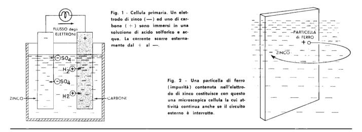
bone e zinco) e di un recipiente che contiene una soluzione diluita di acido solforico ( $H_2SO_4$ ) e di acqua ( $H_2O$ ) La tensione presente tra gli elettrodi è in relazione al materiale che li costituisce ed alla composizione della soluzione; la differenza di potenziale tra elettrodi di carbone e di zinco in una soluzione diluita di acido e acqua ammonta a circa 1,5 volt, e, nella maggior parte delle cellule primarie, la tensione prodotta non supera mai i 2 volt.
