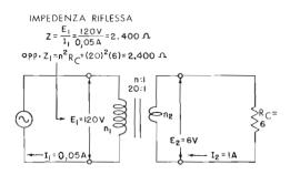
Fig. 2-A — Con un trasformatore a rapporto in discesa (20:1); l'impedenza che il carico del secondario (6 ohm) riflette sul primario è pari a detto carico moltiplicato il quadrato del rapporto delle spire ( $6 \times 20^2 = 2.400$  ohm).
