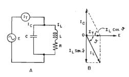
Fig. 8 — Nel circuito (figura A) vi è sempre una certa resistenza, R, dovuta al conduttore che forma « L ». Detta resistenza impedisce uno sfasamento di 180° esatti (vedi B) e di conseguenza la corrente di linea non può scendere a zero.
