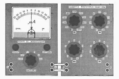
dalla posizione laterale si porta in quella centrale, cioè in prossimità dello zero. Se lo spostamento di detto indice è verso destra, occorrerà aumentare il valore di Rs, e viceversa.
