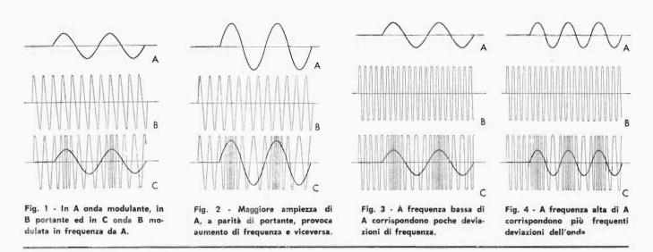
Nella modulazione di frequenza, l'ampiezza del segnale modulante determina la variazione della frequenza portante, il cui valore si allontana da quello centrale proporzionalmente.
