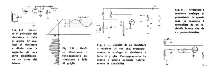
resistenza di carico anodico,  $R_2$ , la quale, allorchè si tratta di un triodo, può essere vantaggiosamente sostituita dall'avvolgimento primario di un trasformatore. Quest'ultimo non potrebbe essere usato nel caso del pentodo, in quanto dovrebbe avere una impedenza praticamente irrealizzabile, ed è allora necessario lasciare una resistenza di adeguato valore, come carico.
