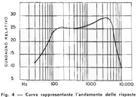
rig. 4 — Curva rappresentante i andamento delle risposte alle diverse frequenze in un amplificatore con accoppiamento a trasformatore. Il tratto uniforme è limitato alla zona centrale.
