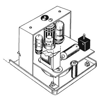
Fig. 5 — Aspetto dello chassis contenente il circuito elettronico. In esso è alloggiato il circuito stampato. Sono visibili le valvole, la batteria, il trasformatore di alimentazione ed il raddrizzatore. Terminato il montaggio, viene fissato posteriormente al pannello.
