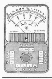
Fig. 1 — Realizzazione tipica di un «tester» in modello tascabile. La costruzione del tipo qui illustrato costituísce argomento della lezione 27<sup>a</sup>.
