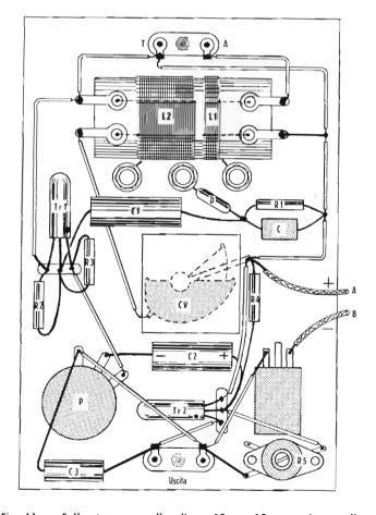
Fig. 11 — Sullo stesso pannello, di cm 10 per 15, suggerito per il ricevitore a 2 stadi, può essere contenuto anche questo ricevitore a 3 stadi. La batteria sarà collegata ai conduttori A e B. Il trasformatore per l'altoparlante è esterno.
