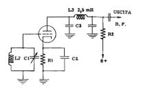
Fig. 4 A — Circuito di principio di un rivelatore per caratteristica di placca. Il segnale a B.F. si manifesta ai capi di R2, dopo essere stato filtrato da C3 ed L3.
