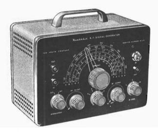
L'oscillatore modulato, (detto anche « generatore di segnali ») mod. « SG-8 », qui descritto, è uno strumento versatile, di facile impiego, e di funzionamento sicuro. La sua realizazione non comporta notevoli difficoltà, in quanto il circuito si basa sull'impiego di stadi oscillatori, analoghi a quelli descritti nella precedente lezione.
