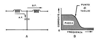
Fig. 12 — In A è riprodotto un filtro « passa basso ». Per comprenderne il runzionarionico esso va considerato come un assieme di circuiti in serie e in parallelo. Le frequenze alte che superano la prima induttanza trovano più facile via tramite il condensatore: quelle basse invece incontrano minore ostacolo nell'induttanza: per questo, passano solo le frequenze basse, come illustrato in B.
