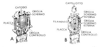
Fig. 1 — In A, struttura interna di un tetrodo: si scorge, tra l'altro, l'elemento aggiunto rispetto al triodo, la griglia schermo, che ha profilo rettangolare. In B, altro tipo di tetrodo, con griglia doppia: interna (come in A), ed esterna.
