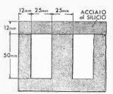
Fig. 3A — Il nucleo di ferro in pratica assume spesso questa forma ed è costituito da un assieme di « lamierini » di ferro al silicio sovrapposti : sono riportate delle misure dimensionali ai fini indicativi dei rapporti.
