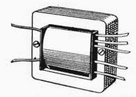
Fig. 9 — Molte volte, allorchè i<sup>3</sup>fili dell'avvolgimento sono di sufficiente diametro, per ragioni di rapidità ed economia costruttiva, vengono sfruttati anche come conduttori per i diversi collegamenti agli altri componenti del circuito. In questo caso sono quasi sempre colorati secondo un codice di colori, di cui riportiamo a pagina 310 due elenchi.
