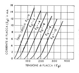
Fig. 6 — Tipica famiglia di curve E<sub>p</sub>-l<sub>p</sub> di un triodo. Ciascuna di esse è riferita a una data tensione di polarizzazione di griglia. La loro interpretazione consente di ricavare dalla valvola le massime prestazioni.
