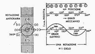
Fig. 9 — Variazioni di ampiezza di una f.e.m. indotta in un conduttore rotante in senso antiorario tra due espansioni polari. Sono indicate le posizioni di rotazione in gradi.
