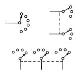
Fig. 5 — Commutatori vari. Vengono definiti rispettivamente: ad 1 via e 6 posizioni; 2 vie e 3 posizieni; 3 vie e 4 posizioni. Le linee tratteggiate indicano il monocomando.
