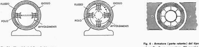
Fig. 5A - Disposizioni delle polarità e senso degli avvolgimenti nel « giogo » di un generatore a due poli. Il circuito magnetico si chiude attraverso il rotore non indicato in figura.
