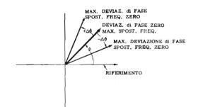
Fig. 14 — Relazione tra deviazione di fase e spostamento di frequenza. Si nota che quest'ultimo è massimo allorchè la deviazione di fase è zero. Alle massime deviazioni di fase è zero lo spostamento di frequenza.
