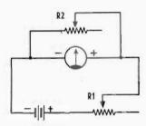
Fig. 9B — Regolata R<sub>1</sub> per la lettura a fondo scala secondo lo schema della figura precedente, si inserisce R<sub>2</sub>: il suo valore massimo è in relazione al tipo di strumento e va da 100 a 5.000 ohm. Si regola R<sub>2</sub> sino a portare in centro l'indice dello strumento, indi la si disinserisce e si misura il suo valore: tale valore corrisponde a quello della bobina mobile.
