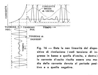
lineare, la forma d'onda che ne risulterebbe conterrebbe entrambe le frequenze. Gli amplificatori a circuiti sintonizzati del trasmettitore amplificherebbero la portante a radiofrequenza, ma eliminerebbero, agli effetti pratici, la componente ad audiofrequenza. In tali circostanze, verrebbe irradiata la sola portante, per cui verrebbe meno il suo scopo di far da tramite ai segnali di «intelligenza».
