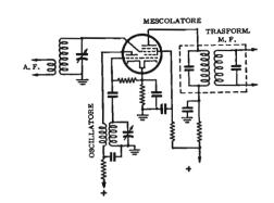
Fig. 6 - Conversione di frequenza mediante un triodo esodo. L'accoppiamento è diretto, in quanto le due unità hanno una griglia in comune.
