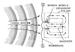
Fig. 7 — Principio di funzionamento del microfono dinamico. La bobina mobile, immersa nel traferro di un potente magnete, ne taglia il campo magnetico allorchè viene fatta vibrare dalla membrana.
