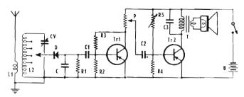
Fig. 10 — Ricevitore formato dallo stadio rivelatore e da due stadi, in « cascata », di amplificazione in Bassa Frequenza, a transistori. Il valore di R<sub>a</sub> viene determinato come è detto nel testo. R<sub>o</sub> è il regolatore di « volume ». È necessaria una batteria — B da 6 volt.
