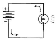
Fig. 13 - In un circuito vi può essere più di'una variabile : nel filamento di una lampadina ad esempio, la corrente non è perfettamente proporzionale alla tensione, poichè la resistenza varia con la temperatura.
