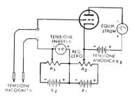
Fig. 8 — Circuito elementare di un voltmetro elettronico a triodo, del tipo detto a «lettura inversa». In questo tipo, per effettuare la lettura, è prima necessario azzerare lo strumento.
