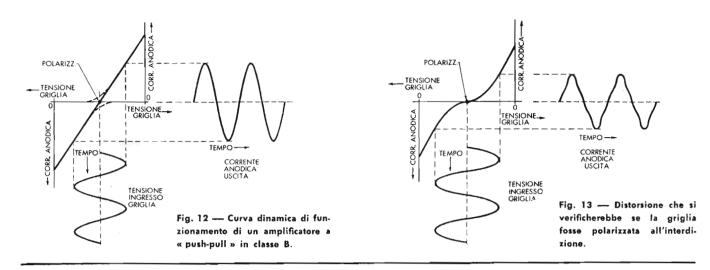
sere sia una valvola che costituisce uno stadio precedente di amplificazione, come qualsiasi altra fonte. Il secondario è provvisto di una presa centrale, e le estremità dell'avvolgimento sono collegate rispettivamente alle griglie di  $V1 \in V2$ . La presa centrale è collegata al lato negativo della sorgente di tensione di polarizzazione.
