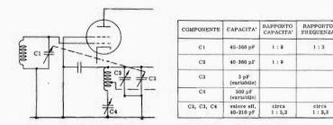
Fig. 9 - Impiego contemporaneo del « trimmer » e del « padder ». Combinando le due funzioni rispettive, è possibile adattare perfettamente i rapporti di capacità delle due sezioni del condensatore variabile, (e quindi rapporti di frequenza) affinchè l'indice della scala parlante del ricevitore indichi esattamente le frequenze riportate sulla scala stessa.
