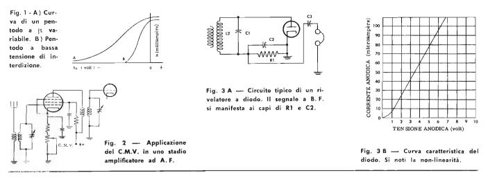
Il segnale a radiofrequenza può passare attraverso diversi stadi di tale tipo prima di essere applicato al rivelatere; passando attraverso tre o quattro circuiti sintonizzati, la selettività viene — come sappiamo — notevolmente aumentata. Ogni circuito, infatti, permette il passaggio della sola frequenza di risonanza, mentre attenua tutte le altre. Anche la sensibiltà aumenta considerevolmente grazie all'amplificazione da parte di ogni singolo stadio.
