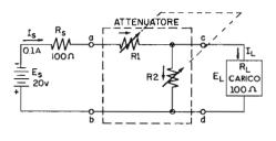
l'impiego di un'altra resistenza variabile per cui il circuito è più complesso di quello dell'attenuatore ad « L ».
