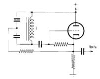
Fig. 3 - Anche per la produzione del segnale a Bassa Frequenza viene impiegato un circuito « Colpitts ». Come si nota, l'accoppiamento reattivo tra placca e griglia ha luogo attraverso l'induttanza avvolta su nucleo ferromagnetico. L'uscita viene prelevata ai capi della resistenza catodica, per cui è a bassa impedenza. Il segnale a 400 Hz così prodotto è anch'esso disponibile in uscita.
