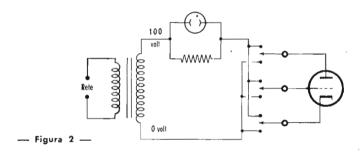
250.000 ohm di resistenza provocano l'accensione della lampada al neon nella prima disposizione, mentre per la prova di dispersione l'accensione è provocata da valori sino a 2 Megaohm. In quest'ultimo caso occorre tener presente l'ammontare delle dispersioni che in realtà possono essere tollerate nel circuito di impiego della valvola sotto prova.
