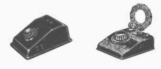
Fig. 20 — Due custodie in bachelite di tipo classico per apparecchi a cristallo. Sono a volte già munite di boccole per l'inserimento dei diversi organi, come si vede a destra; in quest'ultima figura si osserva anche l'impiego della bobina a nido d'apo.
