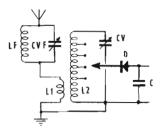
Fig. 13 — La selettività dei ricevitori descritti può essere notevolmente aumentata inserendo in serie al collegamento d'antenna, il circuito filtro accordato LF-CVF che sarà sintonizzato sulle frequenze interferenti. Per LF è pratico scegliere una bobina a nido d'ape (G.B.C. mod. 0/486, trascurando l'avvolgimento primario) e per CVF si può adottare qualsiasi variabile con capacità massima dai 365 ai 500 pF.
