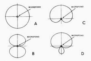
Fig. 9 — A) Curva panoramica; B) Curva bidirezionale; C) Curva cardioide: D) Curva ipercardioide.
