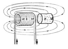
Fig. 19 - Un corpo di materiale magnetico si magnetizza, per le linee di forza di un campo adiacente, con polarità opposta a quella del campo stesse, per cui viene attratto.
