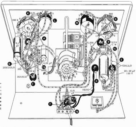
Fig. 8 - Aspetto del telaio maggiore, montato, visto internamente. Anche qui, per facilitare la realizzazione, sono stati riportati i valori di alcuni componenti. I colori dei collegamenti al trasformatore devono essere rispettati. I numeri di riferimento presenti ai contatti del commutatore sono riportati anche sullo schema elettrico di Figura 1.
