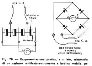
di un assieme rettificatore-strumento a bobina mobile, per letture di corrente alternata. Il raddrizzamento per entrambe le semionde, è ottenute con circuito a ponte.
