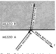
Fig. 11 - Un'onda (incidente) incontrando un corpo solido (D) può esserne riflessa (F); passando da un mezzo A ad un mezzo B può essere rifratta (E)
