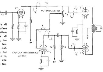
minato e consiste nel collegarne due in opposizione di fase o « push-pull », nel qual caso le valvole, come abbiamo visto, possono funzionare in classe A, AB o B a seconda della potenza desiderata. Nel caso di funzionamento in classe B, si usa un triodo di potenza funzionante in classe A per fornire alle griglie il segnale necessario; si preferisce un triodo a causa della sua bassa impedenza di placca.
