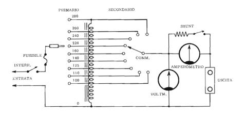
Fig. 6 — Circuito elettrico completo dell'autotrasformatore illustrato in figura 5. Il fusibile in serie al circuito primario serve come protezione dell'intero apparecchio. È conveniente installarlo in una scatola di ferro, ad evitare la presenza di flussi dispersi che potrebbero influenzare le apparecchiature alimentate.
