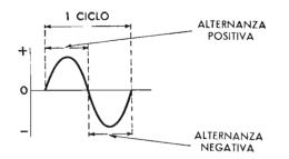
Fig. 1 — Ancora una **riproduzione** del caratteristico andamento della corrente alternata, con la sua inversione di polarità e la **rappresen**tazione di 1 ciclo. La forma d'onda, ossia la variazione nel tempo, è quì, sinusoídale.
