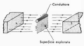
te naturale o artificiale, ed è importante notare che, in entrambi i casi, le linee di forza magnetica e il campo magnetico circostante ad un conduttore percorso da corrente sono della stessa natura di quelle prodotte da un magnete naturale. Abbiamo già dettagliatamente visto i fenomeni dell'elettromagnete alla nostra 13<sup>a</sup> lezione.
