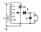
Fig. 1 - Schema elettrico del ricevitore semplice. L'energia raccolta dal circuito « antenna-L1-terra » viene trasferita per induzione al circuito sintonizzato L2-CV; a tale circuito è opportunamente accoppiato il cristallo rivelatore D all'uscita del quale si hanno solo correnti di frequenza acustica che la cuffia traduce in suoni.
