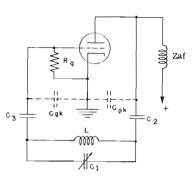
Fig. 13 B - Circuito equivalente dello oscillatore di Fig. 13 A. Come si nota, le capacità interelettrodiche formano un partitore.
