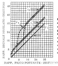
Fig. 14 - Andamento del rapporto segnale - rumore rispetto al rapporto ampiezza di picco della portante-rumore, per indice di modulazione 1 e 4. La diagonale A, inserita per un confronto, è relativa all'andamento con la modulazione d'ampiezza.
