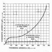
Fig. 13 — Curve caratteristiche di due tipi di cellule. Come si nota, il rendimento del tipo a gas è maggiore.
