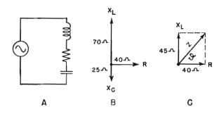
Fig. 1 — Nel circuito risonante in serie (figura A) alla maggiore reattanza induttiva (X<sub>L</sub>) può essere sottratta la reattanza capacitiva (X<sub>C</sub>) dato lo sfasamento di 180° (figura B). L'impedenza netta risulta essere (figura C) una resistenza pura in serie alla reattanza induttiva pura, residua.
