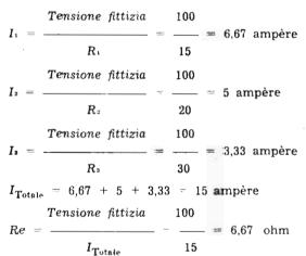
Se non si usa il regolo, un'alternativa del metodo consiste nello stabilire una tensione fittizia numericamente eguale al valore della resistenza maggiore.
