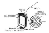
Fig. 11B — La bobina mobile è formata da diverse spire di filo sottile avvolte su un telaio di alluminio che può ruotare su due perni. Due molle a spirale frenane il movimente e provocano il ritorno alla posizione di partenza quando cessa la corrente.
