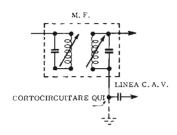
Fig. 4-A Metodo per bloccare provvisoriamente il funzionamento dell'oscillatore, durante le operazioni di allineamento della M.F.
