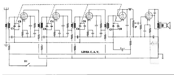
Fig. 16 - Schema tipico di un ricevitore a stadi accordati a cinque valvole. Le prime tre amplificano in Alta Frequenza: la quarta rivela e amplifica in Bas-Frequenza, La sa quinta è la finale le di potenza. Si notino il C.M.V. (P), ed il circuito C.A.V.
