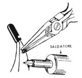
Fig. 8 — Le saldature degli elettrodi del transistore devono essere effettuate con rapidità. Per evitare la propagazione del calore all'interno, si ricorra ad una grossa pinza che con la sua massa disperde il calore propagantesi.
