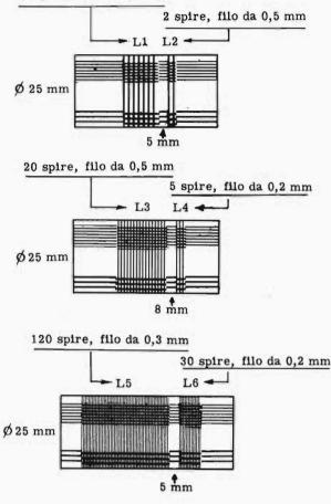
Fig. 2 — Dati costruttivi dell'induttanza.
