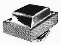
Fig. 14 — Nel caso di montaggio orizzontale del trasformatore si può adottare, così come si è visto per il serrapacco, un'unica calotta. Anche qui la calotta elimina spesso il serrapacco e protegge l'avvolgimento.
