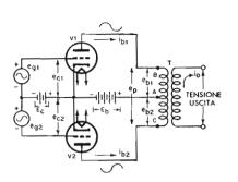
Fig. 10 — Circuito di amplificazione in controfase. I segnali delle due placche sono di fase opposta, e si integrano nel primario di T.
