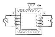
Fig. 6 B --- Se si impiega un nucleo ferroso le linee magnetiche restano nel nucleo e influenzano quasi tutte il secondario : evidentemente, il rendimento del trasformatore ne è accresciuto.
