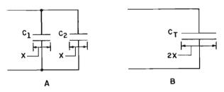
Fig. 5 — Collegando due condensatori in parallelo, C<sub>1</sub> e C<sub>2</sub>, ciascuno con superficie « X » delle armature (figura A) avremo lo stesso effetto che se adottassimo un condensatore unico, CT, con superficie (figura B) pari alla somma delle superfici (2X): in altre parole, maggiore capacità. La tensione ammissibile di lavoro, rimane quella del condensatore a tensione più bassa.
