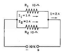
Fig. 6 — La corrente che la sorgente deve fornire, in un circuito in parallelo, è pari alla somma delle correnti dei diversi rami, cioè:  $I_T = I_1 + I_2$ .
