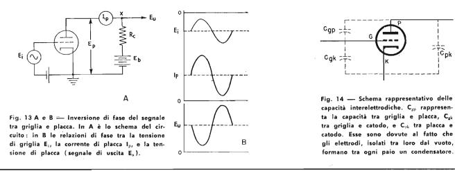
tensione base in modo da aumentarne il potenziale negativo, avviene il contrario, ossia la corrente anodica diminuisce. In conseguenza di ciò, diminuisce la caduta di tensione IR ai capi della resistenza di carico,  $R_c$ , per cui la tensione istantanea nel punto X aumenta rispetto al suo valore precedente, assumendo un nuovo valore pari alla differenza tra la tensione di alimentazione e la caduta attraverso  $R_c$ .
