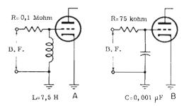
Fig. 12 - In A dispositivo di preenfasi ottenuto con resistenza e induttanza. In B dispositivo di deenfasi da contrapporre alla preenfasi di A (è ottenuto con resistenza e capacità).
