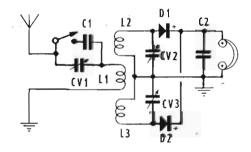
Fig. 6 - Sichema ellettrico del ricevitore a cristalli in controfase. Questa nicevitore permette risultati che nessun altro apparecchio a semplice cristallo può consentire; presenta sensibilità e selettività massime e com buoma antenna rende possibile l'ascolto dii un notevolle numero di stazionii. Alla figura 7 — schema costruttivo riportiamo l'elenco del materiale occomente.
