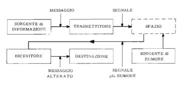
Fig. 13 - Schema a blocchi di un sistema di comunicazioni, ove è in evidenza come venga ad introdursi il fattore rumore che altera la fedeltà dell'informazione.
