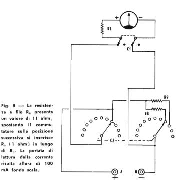
Naturalmente  $C_1$  è in posizione per C.C. Del commutatore C2 vengono interessate due distinte sezioni: esso è, nel disegno, in posizione di lettura 10 mA a fondo scala. La resistenza « shunt » in funzione è R, e si può facilmente osservare che tale resistenza risulta in parallelo alle boccole d'entrata ed allo strumento; per variare la portata, C2 inserisce un valore più basso.
