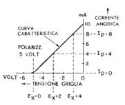
Fig. 2B — Grafico illustrante il funzionamento del circuito di figura 2A. I<sub>p</sub> si manifesta soltanto quando la tensione da misurare  $E_x$  à positiva.
