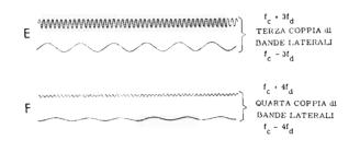
Fig. 8 - In E la terza coppia di bande laterali con le due frequenze estreme, e così pure in F la quarta ed ultima coppia. Le ulteriori coppie non superano il livello dell'1% e sono perciò trascurabili.
