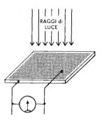
Fig. 15 - Produzione di corrente mediante la «cellula solare ». Essa è composta di un materiale (selenio o silicio) che emette una corrente elettrica proporzionale (fino ad un certo valore massimo), alla luce che lo colpisce.
