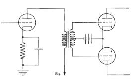
Fig. 9B — Accoppiamento a trasformatore tra uno stadio pilota ed uno stadio finale in « push-pull ». Il segnale presente ai capi del secondario viene applicato alle due griglie contemporaneamente, con fase opposta.
