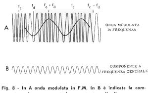
ponente a frequenza centrale o portante: alle figure seguenti le diverse coppie di bande laterali.
