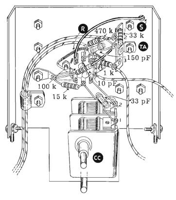
Fig. 7 - Aspetto del telaio minore dopo il montaggio. Per maggiore chiarezza, sono stati riportati i valori dei vari componenti.
