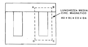
Fig. 17 — La lunghezza media del circuito magnetico è rappresentata dalla linea tratteggiata. Può essere calcolata sommando all'altezza della finestra il lato minore del pezzo ad « I » e la larghezza del gambo centrale, indi moltiplicando la somma per due.
