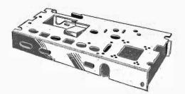
Fig. 10 - Aspetto di un telaio o « chassis » prima del montaggio. I fori di varie forme e misure sono predisposti per il montaggio dei componenti più ingombranti: I componenti di minori dimensioni ( resistenze, condensatori, ecc.), vengono a far parte del cablaggio e restano opportunamente collocati al di sotto dello « chassis ».
