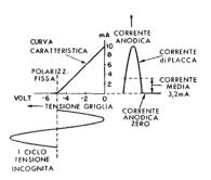
Fig. 3B ---- Analisi grafica del funzionamento del circuito di figura 3A. La corrente anodica si manifesta soltanto durante i semiperiodi positivi del segnale applicato (da misurare).
