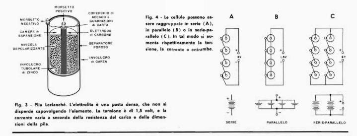
mentre la corrente scorre, provoca delle bolle di idrogeno le quali si formano in gran numero sulla superficie dell'elettrodo positivo di carbone finchè questo ne è completamente ricoperto. Tale azione si chiama *polarizzazione*. Alcune di queste bolle salgono alla superficie e si liberano nell'aria, tuttavia, molte di esse restano sull'elettrodo finchè non rimane spazio sufficiente affinchè se ne formino altre.
