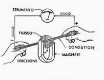
Fig. 2 — Un conduttore mosso tra le espansioni polari di un magnete, viene percorso da una corrente che cambia di senso per un movimento in senso opposto del conduttore stesso: si genera così corrente alternata. Fig. 3 — Se il conduttore è iungo 1 cm e si muove verticalmente verso il ba≋so alla velocità di 1 cm al secondo, descrive una superficie di 1 cm<sup>2</sup> che è attraversata dalle linee di forza del magnete,
