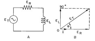
Fig. 12 — In un circuito con resistenza ed induttanza in serie (figura A) si devono sommare vettorialmente la tensione ai capi di R (che è in fase con la corrente) e la tensione ai capi di L (che è sfasata di 90") per conoscere la tensione risultante « ET » (figura B).
