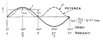
Fig. 12 — La potenza sviluppata da una corrente alternata può essere rappresentata con una curva, le cui ondutazioni sono positive anche quando la direzione della corrente è negativa.
