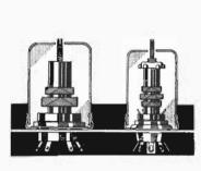
Fig. 19 — Bobina racchiusa in apposito contenitore a effetto schermante.
