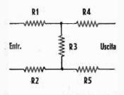
Fig. 6B bis — Attenuatore act  $\alpha$  H »: è un'elaborazione del tipo a  $\alpha$  T ». In esso, se necessita la simmetria,  $R_1 = R_2 = R_4 = R_5$  e tutte corrispondono a metà valore di  $R_1 - R_3$  di figura 6B.
