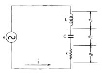
Fig. 2 — Circuito con L-C-R in serie. I simboli rappresentano valori istantanei (per cui  $e = e_R + e_L + e_C$ ) che non consentono l'applicazione della legge di Ohm.
