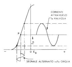
Fig. 8 — Curva caratteristica E<sub>g</sub>·l<sub>p</sub> di un triodo. Essa dimostra come la « pendenza » determini l'ammontare dell'amplificazione. In basso è rappresentato il segnale di ingresso, e a destra quello di uscita (amplificato).
