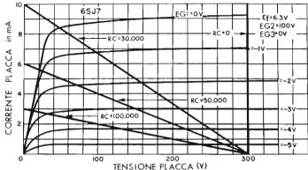
Fig. 9 — Rette per diversi valori di carico di placca di un pentodo. Più alto è il valore e minore linearità si riscontra.
