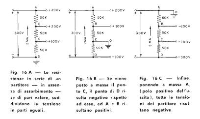
tore, le tensioni alle prese variano. Per avere una buona stabilità delle correnti prelevate dalle prese intermedie, esse devono essere pari ad una frazione relativamente piccola della corrente totale che percorre il partitore.
