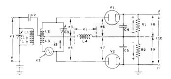
Fig. 15A - Rivelatore per F.M. del tipo a discriminatore. La tensione d'uscita, e10, varia in polarità ed ampiezza in relazione alle variazioni di frequenza della tensione di entrata e1.
