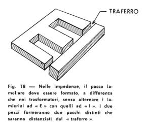
una facile saturazione, il circuito stesso deve essere brevemente interrotto. Per questo fatto, i lamierini non devono essere infilati alternativamente come abbiamo visto essere necessario per i trasformatori. Si formerà il pacco così come dalla **figura 18**, ed in tal modo si potrà interrompere il circuito del ferro distanziando leggermente l'assieme dei pezzi ad «I» da quelli ad «E». Come è noto, questo spazio d'aria viene detto **traferro**. Occorre calcolarne lo spessore.
