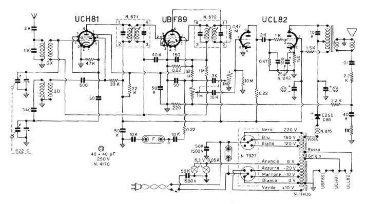
Schema elettrico del ricevitore e, sotto, elenco del materiale necessario. Pur impiegando tre sole valvole, il ricevitore corrisponde perfettamente, nei risultati, al classico apparecchio a 5 valvole di alcuni anni fa. Si noti che in Bassa Frequenza si hanno due stadi: un triodo amplificatore di tensione ed un pentodo finale. La valvola
