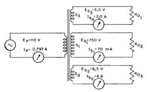
Fig. 15 — In sede di calcolo costruttivo di un trasformatore come quello qui illustrato, tipico degli apparecchi radio, si tiene conto di una differenza tra l'ammontare della potenza primaria e quello della potenza secondaria.
