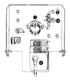
Fig. 3 - Disposizione di alcuni componenti sulla parte inferiore del telaio di Figura 2. Si noti la posizione del condensatore variabile e della basetta di ancoraggio. A quest'ultima fanno capo le resistenze ed i condensatori facenti parte del circuito di Alta Frequenza.
