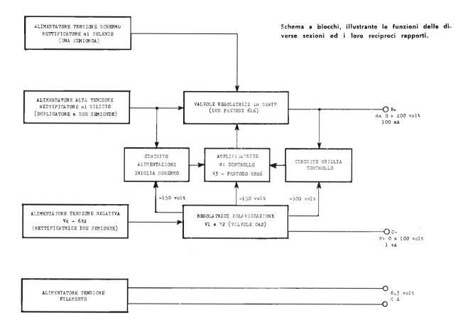
tensioni provenienti da trasformatori separati da quelli che erogano l'alta tensione. In questo modo viene resa possibile la temporanea esclusione di tutte le tensioni elevate, lasciando però in funzione quelle di accensione. Durante le normali prove di laboratorio, questa possibilità evita al tecnico di aspettare che le valvole abbiano nuovamente raggiunta la temperatura di funzionamento, ogni volta che egli deve disinserire l'apparecchio sotto prova per intervenire nel circuito.
