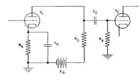
Fig. 5 — Accoppiamento RC tra due stadi in **Bassa** Frequenza. Il segnale amplificato da V1 si sviluppa ai capi di R<sub>c</sub>, e, tramite C<sub>c</sub> passa sulla griglia di V2, mentre la componente continua resta bloccata.
