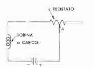
Fig. 3A - Schema tipico di inserimento di un reostato. Spostando il cursore verso sinistra, aumenta la tensione ai capi della bobina, nonchè la corrente; il contrario avviene per lo spostamento inverso.
