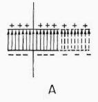
Fig. 3 A — La differenza di potenziale tra le due armature spinge le linee di flusso — qui rappresentate dalle frecce — all'interno del dielettrico. Se aumenta la superficie (parte tratteggiata) aumenta il numero di linee.
