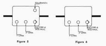
Quando invece i punti colorati sono tutti presenti, l'ultimo a sinistra della fila inferiore rappresenta spesso la massima tensione di funzionamento, come segue:
