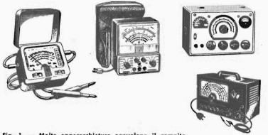
Fig. 1 — Molte apparecchiature agevolano il compito del radiotecnico: alcune sono portatili, altre fisse, da laboratorio.
