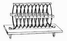
Fig. 1 — Induttanza tipica per trasmissione su onde corte. Anzichè in filo di rame viene spesso costruita con tubetto di rame, argentato: a pagina 225 è detto del motivo di ciò. La basetta munita di spinotti la rende intercambiabile.
