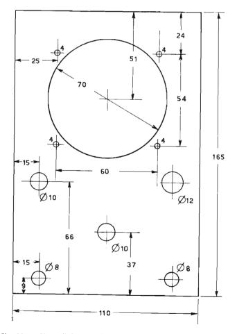
Fig. 11 — Piano di foratura del pannello frontale che supporta tutti gli organi (ad eccezione della batteria) e l'intero montaggio. Le quote sono espresse in millimetri e, naturalmente, sono in dipendenza del tipo di materiale adottato.
