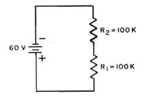
Fig. 8A — Se ad un circuito formato da due resistenze di eguale valore (100 kohm) in serie tra loro, sono avvîati 60 volt, avremo ovviamente 30 volt ai capi di ogni singola resistenza.
