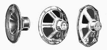
Fig. 10 — Aspetto di tipici altoparlanti dinamici. Si notino le ondulazioni presenti sul bordo esterno del cono, che ne agevolano la vibrazione. Il terzo a destra è di forma ellittica.
