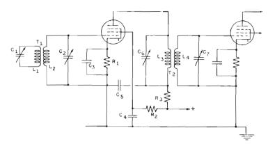
Fig. 11 - Circuito tipico di un amplificatore a Media Frequenza. L<sub>1</sub> - L<sub>2</sub> - L<sub>3</sub> - L<sub>4</sub>, con le rispettive capacità in parallelo, costituiscono i circuiti risonanti necessari per l'accoppiamento.
