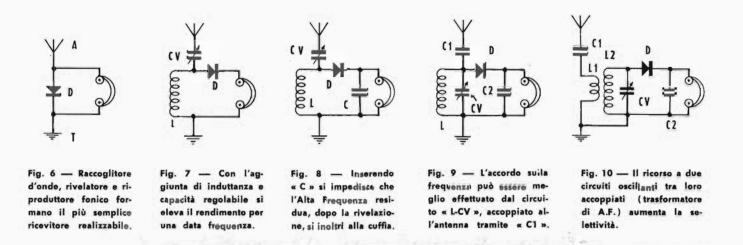
vorevoli, possiamo pervenire all'ascolto, passando a quello di figura 7 noteremo, in particolare per un dato valore del condensatore (che dipende dalla frequenza che si vuole sintonizzare), un aumento notevole della intensità sonora; inoltre verrà aumentato anche il raggio entro il quale l'ascolto può aver luogo, vale a dire che in località in cui con il primo ricevitore non è dato di effettuare alcun ascolto, con il secondo tale ascolto può invece verificarsi.
