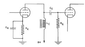
Fig. 8 — Accoppiamento LC. L'impedenza si comporta come una resistenza di carico, ma offre una bassa resistenza alla corrente continua, per cui la tensione di placca può essere maggiore che non nel tipo RC.
