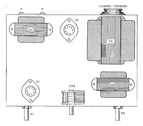
Fig. 3 — Suggerimento per la predisposizione delle parti su di un telaio di alluminio o ferro, di cm  $20 \times 14$ , alto 6 cm. Se proprio necessario, si può fare in modo che l'assieme occupi minore spazio avvicinando i diversi componenti, ma lasciandoli reciprocamente collocati così come indicato. Il lato frontale sarà munito di pannello metallico.
