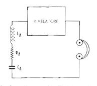
Fig. 2 — L'antenna in effetti è un circuito sintonizzato, presentante la propria induttanza LA, la propria capacità CA ed una propria resistenza RA. Come circuito sintonizzato inizia il processo di selezione.
