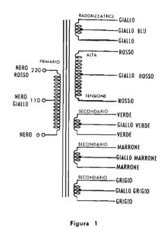
I colori elencati caratterizzano il materiale isolante (cotone o plastica) che riveste i terminali di uscita del trasformatore.
