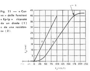
necessita per tracciare la curva I-E di una semplice resistenza.
