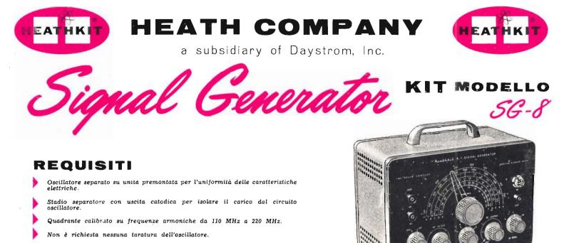
3 uscite diverse: RF non modulata, RF modulata, BF a 400 Hz.
