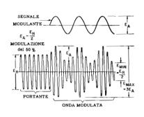
Fig. 4 — Se la tensione modularte è pari a metà della tensione della portante, la percentuale di modulazione ammonta al 50 %.
