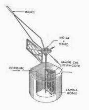
Fig. 3 — Strumento a ferro mobile, con alette radiali. Il perno, rotante e recante l'indice, è solidale con una aletta : l'altra aletta è fissa.
