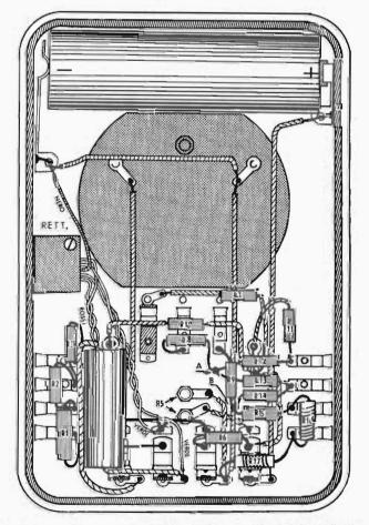
Fig. 8 — Assieme a collegamenti terminati e pila inserita nel suo alloggiamento.
