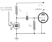
Fig. 4 B — Circuito tipico di collegamento di un microfono a condensatore al primo stadio di amplificazione. La tensione viene fornita dallo stesso alimentatore.
