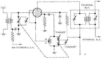
Fig. 5 - Impiego dell'eptodo come convertitore. In tal caso, l'oscillatore è incorporato, ed è costituito dalle prime due griglie.
