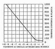
Fig. 11 — Curva caratteristica di un « thyratron » esprimente le relazioni tra le tensioni di griglia e di placca.
