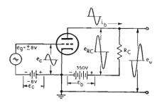
Fig. 2 — Relazioni di fase tra le tensioni e le correnti alternate in un amplificatore a triodo. Come si nota, il segnale di uscita è sfasato di 180° rispetto al segnale di ingresso applicato alla griglia.
