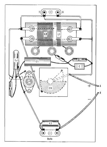
Fig. 5 — Pannello recante tutto il montaggio dell'apparecchio. I tre conduttori uscenti dal transistore (Tr<sub>1</sub>) sono ancorati ad una basetta: essi, per chiarezza di disegno, appaiono nudi, ma è opportuno, come è detto nel testo, che siano ricoperti di tubetto sterling. I conduttori A e B devono essere connessi alla batteria.
