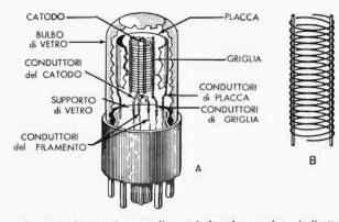
Fig. 1 — Aspetto interno di un triodo ad accensione indiretta sezionato. In A sono visibili tutti gli elettrodi nelle rispettive posizioni : in B è visibile la griglia ingrandita.
