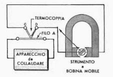
Fig. 10 — Misuratore a « termocoppia ». La corrente da misurare passa nel filo « A », riscalda il filo e quindi la coppia bimetallica. Ai capi di quest'ultima (tra C e D) si forma una corrente continua che viene letta dallo strumento a bobina mobile.
