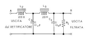
Fig. 15 — Filtro a induttanza e capacità; detto ad « ingresso induttivo ». La tensione di uscita è inferiore a quella del filtro di figura 14: per contro, le variazioni dovute al carico sono meno rilevanti.
