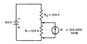
Fig. 88 — I 30 volt presenti nel caso della figura a fianco non sono più tali se ai capi di una resistenza viene posto uno strumento a bassa resistenza totale, dato il suo notevole assorbimento.
