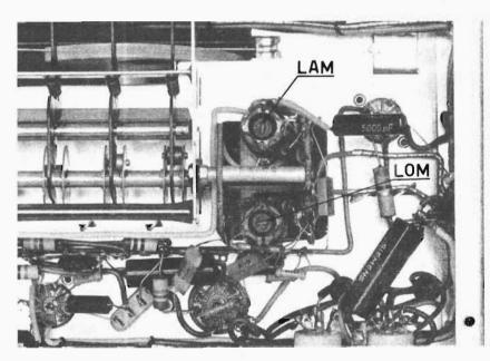
Fig. 3 - Punti di taratura accessibili della parte inferiore dello chassis. Interessano solo la gamma delle Onde Medie e sono: LAM, nucleo della bobina d'entrata (aereo) ed LOM, nucleo della bobina dell'oscillatore. Il primo, come è detto nel testo, va regolato per la massima uscita, ed il secondo per la corrispondenza dell'indice con la scala.
