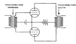
Fig. 13 — Stadio finale in « push-pull » con ingresso e uscita a trasformatore. Il primo trasformatore fornisce il segnale alle griglie con polarità opposta, ed il secondo integra le due uscite in un unico segnale.
