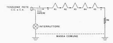
Fig. 3 — Circuito relativo all'accensione di filamenti di valvole ( $R_1$ ,  $R_2$ , ecc.) in serie. La resistenza  $R_6$  chiude il circuito e viene scelta di valore tale da far sì che tra i punti « a » ed « f » sìa presente una tensione pari alla somma delle tensioni necessarie per ogni singola valvola.
