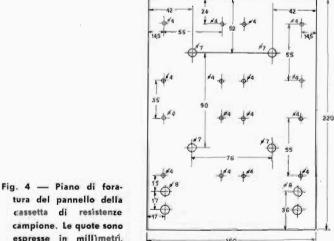
tura del pannello della cassetta di resistenze campione. Le quote sono espresse in millimetri.
