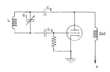
Fig. 13 A - Circuito di principio di un oscillatore « ultraudion » per la produzione di oscillazioni a frequenza molto elevata. Anche in questo caso la reazione si verifica attraverso la capacità interelettrodica.
