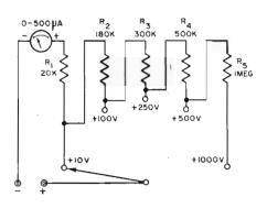
Fig. 2C — Secondo questa soluzione, le resistenze per le varie portate sono sempre in serie allo strumento, ma anche in serie tra loro. La scelta è fatta con commutatore.
