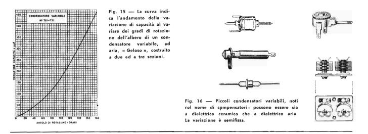
detti microvariabili, la cui capacità massima è dell'ordine di 5 pF (0,000005  $\mu$ F).
