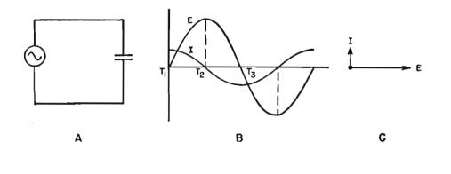
Fig. 7 — Una sorgente di corrente alternata (figura A) fornisce la tensione « E » (figura B) ad un condensatore. Nell'istante «  $T_1$  » la tensione è a zero (e la corrente è al suo massimo valore), in «  $T_2$  » il massimo è raggiunto d. « E » (e la corrente è a zero): si rigetono poi le posizioni con la semionda negativa. Ne risulta che la corrente anticipa di 90°, così come dimostra la rappresentazione vettoriale alla figura C.
