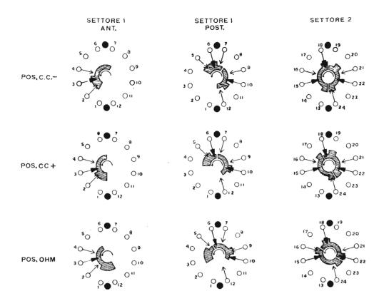
Fig. 8 — Schema dei settori del selettore. Sono rappresentate le tre posizioni relative alle tre possibilità di impiego. I numeri di riferimento ai vari contatti, riportati anche sullo schema elettrico, faciliteranno notevolmente il lavoro di montaggio.
