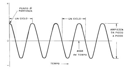
Fig. 5 - Un'onda è una vibrazione che si propaga, Rispetto ad un livello zero (o) una metà dell'onda può essere definita « positiva » (+) e l'altra « negativa » (--). Tra il massimo positivo e quello negativo (tra i picchi) si ha « l'ampiezza » dell'onda. La distanza tra due picchi (oppure tra inizio e fine) costituisce un « ciclo » completo dell'onda. Il numero di cicli che si verifica nel tempo di 1 secondo definisce la « frequenza » di quell'onda.
