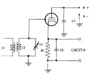
Fig. 5 — Circuito di un rivelatore ad impedenza infinita. Il segnale a B.F. si manifesta ai capi di R1 e di C2.
