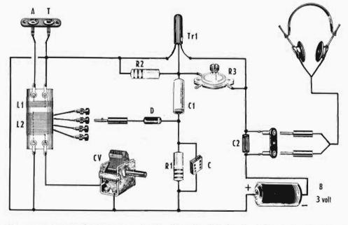
Fig. 6 — Schema elettrico-pratico del ricevitore. Risulta molto utile per il controllo dei collegamenti e delle parti. Elenco del materiale occorrento: 1 tubo di cartone bachelizzato - diametro 2,5 cm - lunghezza 10 cm - Filo di rame smaltato, da 0,22 mm, 15 m circa. Per L1 = 20 spire; per L2 = 112 spire affiancate (tra L1 ed L2 = 4 mm). 1 condensatore variabile ad aria CV - capacità pF 365 (può anche essere da 500 cm - G.B.C. N° 0/132).
