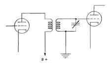
Fig. 2 — Un condensatore variabile, collegato in parallelo al secondario del trasformatore di accoppiamento, rende lo stadio sintonizzato. La frequenza di funzionamento dipende dai valori di induttanza e capacità del circuito LC.
