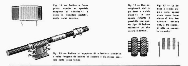
filo da un'estremità all'altra della bobina in modo da ottenere un avvolgimento a spire incrociate con un passo determinato a priori. Il vantaggio delle bobine a nido d'ape, generalmente realizzate con filo del tipo Litz, consiste nel fatto che, con un minimo ingombro, è possibile ottenere alti valori induttivi di avvolgimenti, caratterizzati anche da un rendimento notevole, vale a dire quindi da minime perdite.
