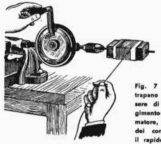
Fig. 7 — Un comune trapano a mano può essere di aiuto nell'avvolgimento di un trasformatore, sia per la posa dei conduttori, sia per il rapido conteggio delle soire.
