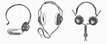
Fig. 17 — Tipi vari di cuffie. Questi riproduttori del tuono possono essere anche monoauricolari, per dar modo a chi ascolta di udire anche i suoni dell'anibiente. Possono essere magnetiche, dinamiche, piezoelettriche : vedremo più avanti tali differenze.
