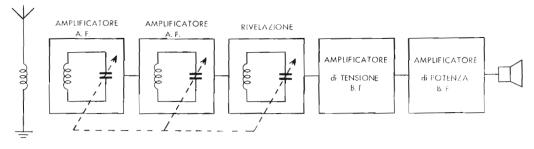
Fig. 9 — Oltre ai componenti indispensabili, un ricevitore che debba consentire una ricezione confortevole di più stazioni in altoparlante, deve possedere circuiti e stadi supplettivi. Cosi, con circuiti sintonizzati si migliorerà la selettività, con stadi di amplificazione in Alta Frequenza la sensibilità, con stadi di amplificazione in Bassa Frequenza la potenza. Per comodità di impiego, i diversi condensatori variabili sono uniti in un unico comando (linee tratteggiate).
