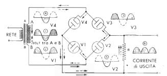
Fig. 4 — Circuito di rettificatore a ponte. Gli elementi di rettificazione funzionano due a due. Durante una semionda il percorso è:  $V_1 - R - V_3$  (frecce a tratto intero); durante l'altra semionda è  $V_1 - R - V_3$  (frecce a tratto interrotto). Le forme d'onda che compaiono nei diversi punti sono numerate in ordine progressivo.
