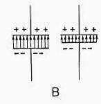
Fig. 3 B — Tra due condensatori di pari superficie, nelle armature, si ha maggiore passaggio di flusso — e quindi maggiore capacità — in quello che presenta minore distanza tra le armature stesse, vale a dire, minore spessore del dielettrico.
