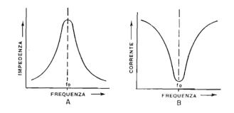
Fig. 6 — Andamento dell'impedenza (in A) in un circuito risonante in parallelo, e della corrente (in B) nello stesso circuito per la frequenza di risonanza. Si noti l'andamento del tutto contrario rispetto a quello del circuito in serie, riportato alla figura 2.
