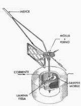
Fig. 4 — Strumento a ferro mobile, con alette concentriche. Le due alette sono l'una nell'altra: il perno, con indice, è solidale con quella interna.
