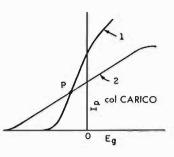
Fig. 11 B — Variazione della curva Eg-l<sub>p</sub> prodotta dalla resistenza di carico nel circuito anodico. La pendenza diminuisce.
