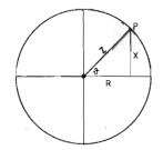
all'asse orizzontale, formiamo un triangolo rettangolo. Contrassegnamo il raggio con la lettera Z, il lato verticale — ossia l'altezza — con X, ed il lato orizzontale — ossia la base — con R; definiamo con la lettera greca  $\theta$  (theta) il numero di gradi dell'angolo che il raggio forma con l'asse orizzontale.
