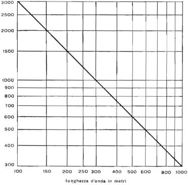
gere il valore della frequenza espressa in kHz. Conoscendo invece la frequenza, è possibile conoscere la lunghezza d'onda in metri che ad essa corrisponde procedendo a ritroso, iniziando cioè con una linea orizzontale che ha inizio in un punto dell'asse verticale corrispondente alla frequenza nota.
