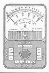
Fig. 8 — In questa realizzazione — della quale è presentata un'ampia descrizione ai fini costrut, vi alla lezione 27<sup>a</sup>, e cloè su questo stesse fascicolo — l'ohmetro fa parte di un assi me capace di letture voltmetriche ed amperometriche, detto « tester » o analizzatore. Le possibilità di lettura ohmetrica sono: 0-20.000 ohm, 0-200.000 ohm, 0-2 Megaohm.
