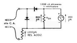
Fig. 11 — Se si inserisce uno « shunt » (R<sub>SH</sub>) allo strumento, si ha sempre un più elevato passaggio di corrente nei raddrizzatori, ciò che elimina l'influenza delle differenti resistenze degli stessi a regimi diversi di corrente.
