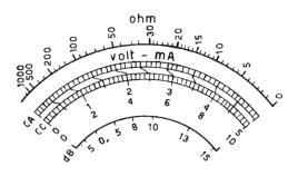
Fig. 10 — Scala che può essere riportata sul milliamperometro.
