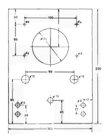
Si eseguirà la foratura dei due pannelli secondo le quote indicate alle figure 3 e 4. Mentre è economico e comodo che le cassette siano in lamiera di ferro da 1 mm di spessore, i pannelli è utile siano in alluminio. Verniciatura e diciture dipendono dai gusti del costruttore: solitamente si ricorre ad una verniciatura alla nitrocellulosa (opaca o lucida) con diciture pantografate, oppure a stampa riportata su targhette protette da celluloide.
