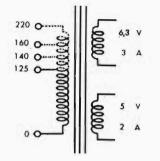
Fig. 4 — Trasformatore di cui viene dato l'esempio di calcolo nel testo. I dati relativi alle tensioni primarie superiori ai 125 volt sono pure esposti, come possibile variante.
