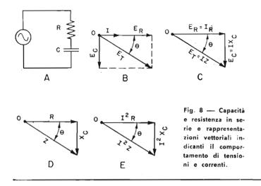
za capacitiva  $X_c$ , e costituisce l'impedenza, la quale viene anch'essa misurata in ohm.
