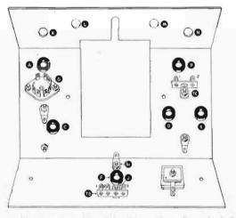
Fig. 5 - Veduta interiore del telaio di maggiori dimensioni. Si noti la posizione dello zoccolo della valvola 6C4, nonchè le basette di ancoraggio. E' visibile anche la posizione del rettificatore ad ossido, che deve essere montato col polo positivo come indicato.
