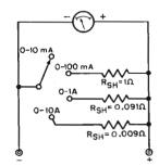
Fig. 5 — Così come per disporre di diverse portate nel caso dei voltmetri si prevedono commutatori di resistenze addizionali (in serie), nel caso dei misuratori di corrente si prevedono, diversi valori di « shunt » (in parallelo).
