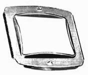
Fig. 12 — Tipico serrapacco per montaggio orizzontale. Assai spesso ne viene usato uno solo in quanto il trasformatore appoggia, dall'altro lato, sulla lamiera dello chassis.
