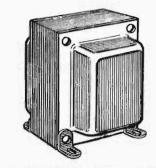
Fig. 13 — Le calotte conferiscono al trasformatore migliore estetica, protezione degli avvolgimenti e schermatura. Molto spesso sono assai rigide sì da fungere contemporaneamente anche da serrapacco.
