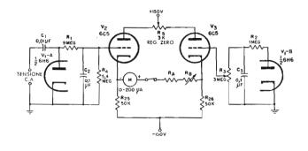
Fig. 6 — Mediante l'aggiunta di un elemento rettificatore, (in questo caso un doppio diodo installato in una sonda), è possibile completare un circuito come quello illustrato nelle figure 5A e 5B, predisponendolo per la misura di tensioni alternate. R<sub>B</sub> è sempre variabile mediante un commutatore, per consentire le diverse portate fondo scala.
