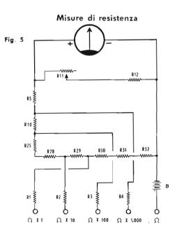
Lo schema (figura 5) risulterà molto chiaro ai nostri lettori che hanno seguito la assai esauriente trattazione che abbiamo esposto in merito agli ohmetri. Stante la ele-
