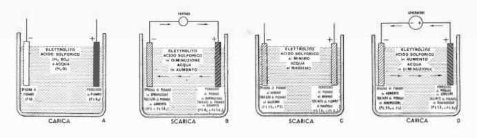
Fig. 7 - Quattro fasi successive dell'attività di una cellula secondaria. E' facile notare le varie reazioni chimiche durante la scarica e la ricarica.
