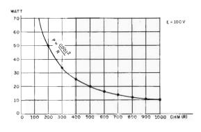
Fig. 11 - Rapporto tra potenza (watt) e resistenza (ohm), relativo ad una tensione del valore costante di 100 volt.
