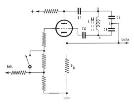
Fig. 2 - Schema separato del circuito « Colpitts » che provvede alla produzione del segnale ad Alta Frequenza.
