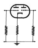
Fig. 5 A — In questo caso, lè griglie dei due triodi hanno la medesima tensione di polarizzazione.
