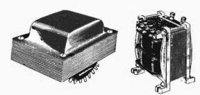
Fig. 23 — Due trasformatori. Il tipo a sinistra viene usato per l'alimentazione di apparecchiature radio ed è montato direttamente sullo « chassis » in un'ampia finestra praticata nello stesso. L'altro modello è a volte adottato nel campo delle frequenze acustiche.
