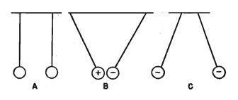
Fig. 5 - Se due corpi elettricamente neutri sono posti a lato (A) non si manifesta alcuna forza di attrazione tra loro; se gli stessi corpi posseggono cariche di polarità opposta (B) essi si attraggono; e se le polarità sono tra loro eguali (C) si respingono.
