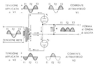
Fig. 3 - Raddrizzamento di due semionde e forme d'onda relative.
