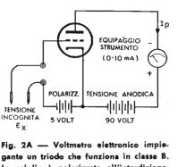
gante un triodo che funziona in classe B. La griglia è polarizzata all'interdizione, ed I<sub>p</sub> esiste quando alla griglia viene applicato una tensione positiva.
