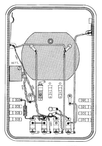
Fig. 7 — Pannello-supporto con mollette e pagliette per saldatura. Sono indicati i primi collegamenti da eseguire.
