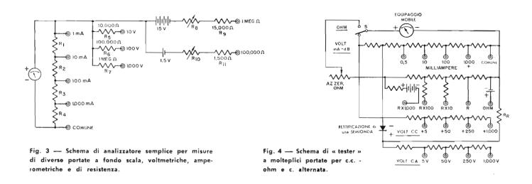
tre di tensione continua e due di resistenza. Vi sono altri strumenti del medesimo tipo che possono comprendere un numero maggiore di portate ohmetriche o di portate voltmetriche o amperometriche. Detto circuito è inoltre limitato alle sole misure in c.c., per cui, allo scopo di estendere la possibilità di misura alla c.a. è necessario aggiungere un raddrizzatore ad ossido con i relativi circuiti.
