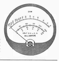
tendenza generale dei tecnici è quella di adottare un « tester » da 5.000 ohm/volt per il servizio fuori sede (strumento portatile) ed un tipo da 20.000 ohm/volt per l'impiego fisso in laboratorio.
