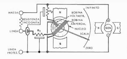
Fig. 7 — Costruzione di un particolare tipo di ohmetro detto Megger. L'indice si arresta in seguito al bilanciamento di due campi magnetici opposti, creati dalla bobina voltmetrica e da quella amperometrica, dipendenti dalla corrente circolante nella resistenza incognita. L'apparecchio genera esso stesso la tensione di funzionamento.
