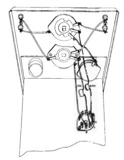
Fig. 8 - Collegamenti tra il commuțatore di frequenza, fissato al pannelio, èd i componenti installati sul telaio. Il commutatore è raffigurato ---- per comodità ---- con le due sezioni separate.
