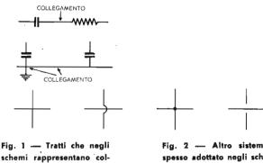
schemi rappresentano collegamenti elettrici, e sistema per indicare un punte di contatto e une di isolamento.
