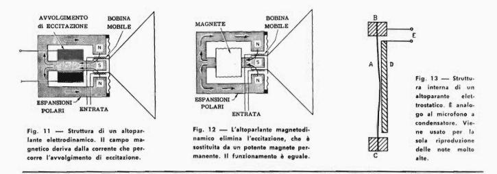
gnetico. Al centro del cono è fissata una bobina supportata da un cilindro di cartoncino leggero, immersa in un campo magnetico costante e di notevole intensità.
