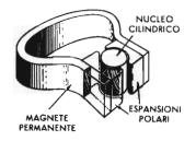
Fig. 11A — Nel classico strumento a bobina mobile si ha anzitutto un magnete permanente a ferro di cavallo con espansioni polari in ferro dolce: tra di esse è inserito un nucleo che accentra ed uniforma il flusso.
