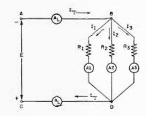
Fig. 4 — Circuito di tre resistenze in parallelo. Ogni resistenza costituisce un circuito a sè. La corrente di linea si suddivide nei tre rami.
