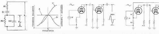
Fig. 15 - Esempio di circuito di sfasamento di un segnale, attraverso una rete RC. Fig. 16 - I due segnali sono in fase per un solo valore di frequenza (F<sub>o</sub>), sulla quale il circuito oscilla.
