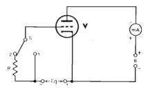
Fig. 4 — Schema di principio per la prova dinamica della conduttanza mutua. Alla griglia, oltre alla tensione di polarizzazione, viene applicato un segnale a corrente alternata.
