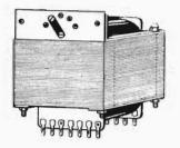
Fig. 5 — Con diverse tensioni previste al primario, si adotta il « cambio-tensioni » che, a volte è montato, come in questa illustrazione, sul trasformatore stesso.
