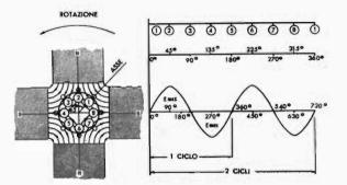
Fig. 10 — Se le espansioni polari sono quattro in luogo di due, in una <u>rotazione</u> si hanno due cicli completi della f.e.m. indotta, in luogo di uno.
