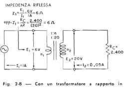
salita (1:20), l'impedenza che il carico (2.400 ohm) riflette sul primario è pari al suo valore diviso il quadrato del rapporto di spire 2.400: $20^2 = 6$  ohm).
