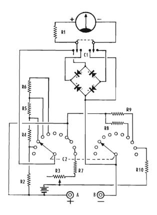
difficile al lettore constatare che trattasi di un modello che seleziona funzioni e portate a mezzo di un commutatore unico, per cui alle due boccole riservate ai puntali, si avranno, volta a volta, possibilità di letture di tensione, corrente o resistenza.
