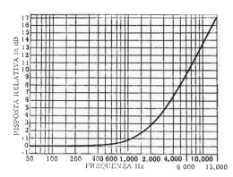
Fig. 11 - Caratteristiche di preenfasi in un trasmettitore. L'uscita a 15.000 Hz è 8 volte più elevata (18 dB) del livello a 1.000 Hz.
