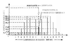
Fig. 6 - Spettro di frequenza di un'onda modulata in F.M. con ampiezza delle frequenze laterali sino all'8ª che dista (per frequenza modulata di 15 kHz) 120 kHz per lato dalla portante.
